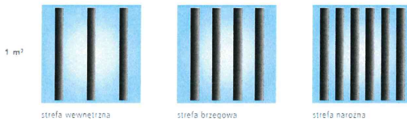
Rys. 4. Schemat nakładania kleju dla budynków do 5m wysokości - klejenie pasmowe
