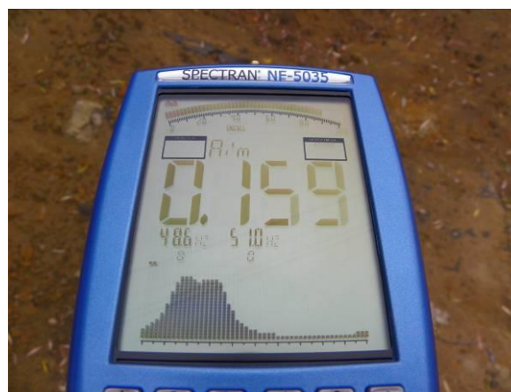
Fot. 48. Pomiar składowej elektrycznej (na lewo) i składowej magnetycznej (na prawo) w punkcie pomiarowym zlokalizowanym w odległości ok. 5 m od transformatora średniego napięcia [fot. Krzysztof Kręciproch]
