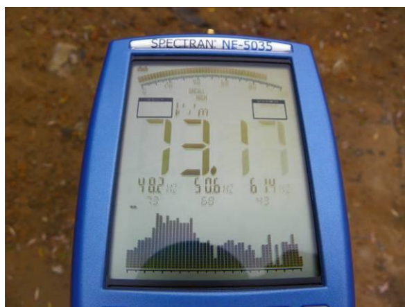
Fot. 48. Pomiar składowej elektrycznej (na lewo) i składowej magnetycznej (na prawo) w punkcie pomiarowym zlokalizowanym w odległości ok. 5 m od transformatora średniego napięcia [fot. Krzysztof Kręciproch]
