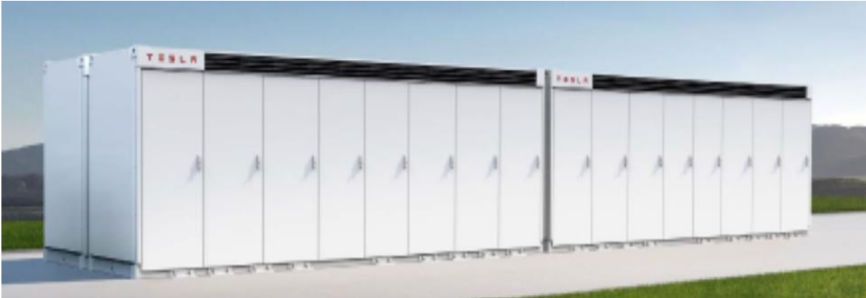
Rysunek 13. Przykładowy magazyn energii o mocy 16 MW i pojemności 32 MWh
