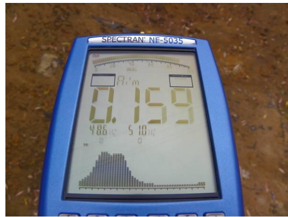
Fot. 11. Pomiar składowej elektrycznej (na lewo) i składowej magnetycznej (na prawo) w punkcie pomiarowym zlokalizowanym w odległości ok. 5 m od transformatora średniego napięcia [fot. Krzysztof Kręciproch]
